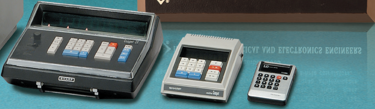
世界初、MOS-IC式電卓 CS-16A (1967年) 世界初、MOS-LSI式電卓 QT-8D (1969年) 世界初、液晶表示式電卓 EL-805 (1973年)
