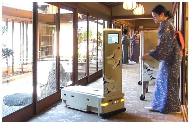
ワゴンを着脱して運用 (写真はワゴン装着に向けて旋回中)
