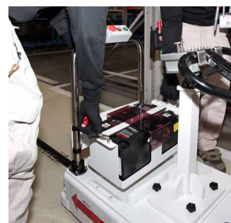
外付けバッテリーを順次交換することで連続運用が実現
