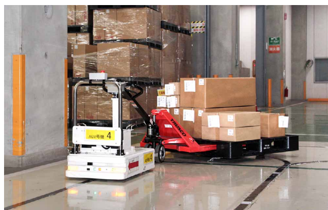
最大500kgの荷物をハンドリフトごと牽引し、目的地へ自動搬送
