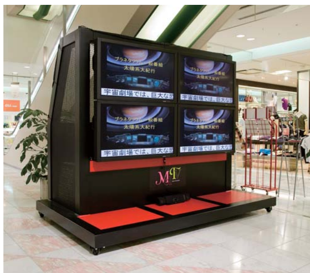
1Fエントランスには、4面マルチの「PN-465」。4画面表示と拡大表示を切り替えながら番組を放映している。可動式の筐体にセットし、イベントでは移動して使用する。
