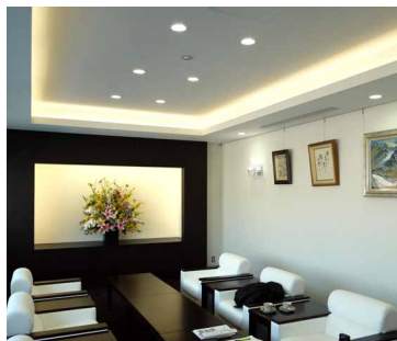
商談室にはダウンライト。 壁の間接照明も全てLED
