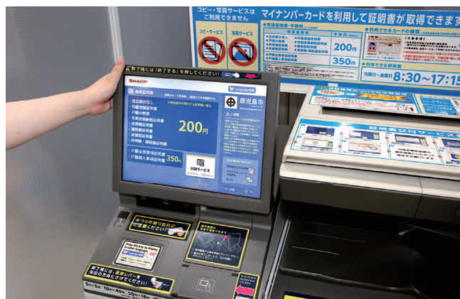
15型タッチパネルは角度調節ができ、小柄な方でも使いやすい
