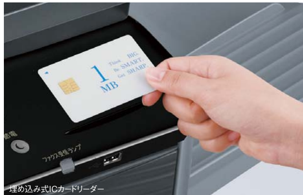
埋め込み式ICカードリーダー
