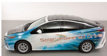
当社製化合物太陽電池を搭載した公道走行実証車「プリウスPHV」
