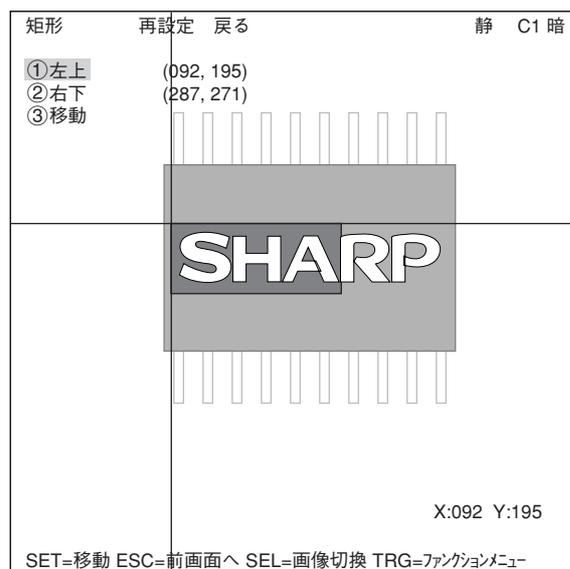
次に「②右下」にカーソルを合わせてSETキーを押し、同様に計測エリアの右下の座標を決定します。
