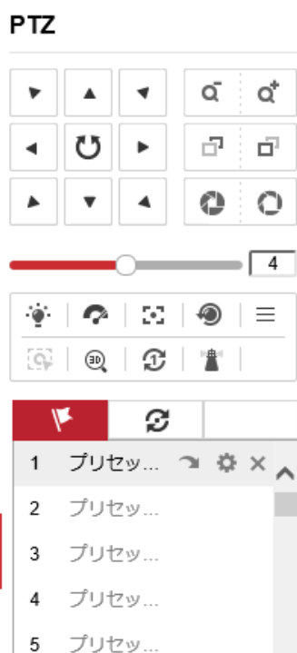
図 4-3 PTZ コントロールパネル
