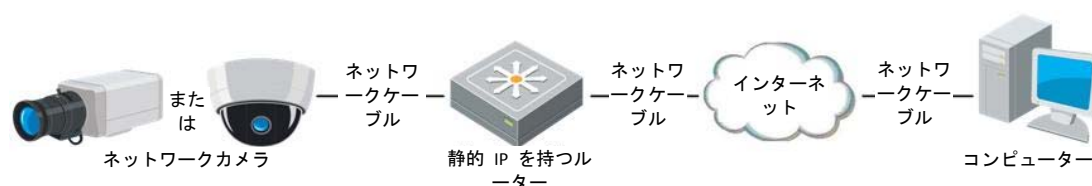
図 2-4 静的 IP を持つルーターを経由したカメラへのアクセス
