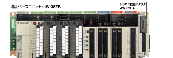
増設ベースユニット・JW-38ZB アナログ出力ユニット JW-22DA 高速カウンタユニット JW-22HC パルス出力ユニット JW-21PS 64点出力ユニット JW-262S I/Oバス拡張アダプタ JW-32EA 電源ユニット JW-22PU アナログ入力ユニット JW-24AD 高速カウンタユニット JW-21HC 64点入力ユニット JW-264N 32点出力ユニット JW-232M
