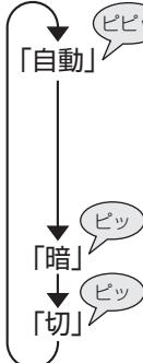
照度センサーに応じて、明るさを変えます
