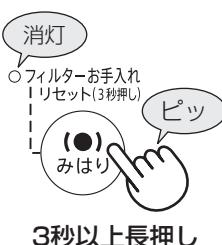
差込プラグをコンセントに差し込み、運転を開始して**みはりボタン(フィルターお手入れリセットボタン兼用)**を3秒以上長押しする(フィルターお手入れランプ消灯)
