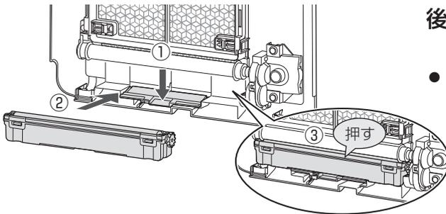
後ろパネルにダストボックスを取り付ける
