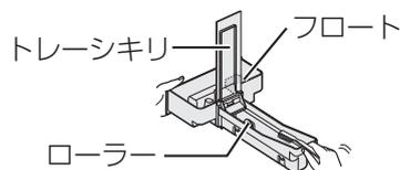
※ トレーシキリ・フロート・ローラーは取りはずさないでください。(水漏れ・故障の原因)
