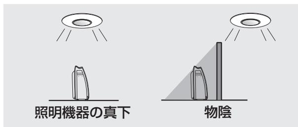
左のような場所に設置した場合は、照度センサーが明るさを正しく検知できないことがあります。お部屋の明るさに合わない運転をするときは、設置場所を調節してください。（センサーの感度を調整することもできます） (22～25 ページ)
