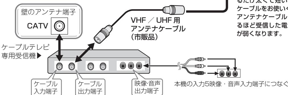
アンテナケーブルは、できるだけ太くて短いアンテナケーブルをお使いください。
