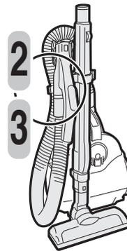
**1** スタンド収納2の状態から、ズームパイプ着脱ボタンを押して手元パイプをはずす。
