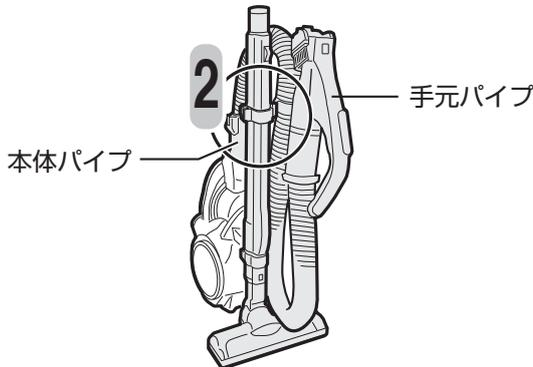
**1** スタンド収納3の状態からズームパイプ着脱ボタンを押して手元パイプをはずす。
