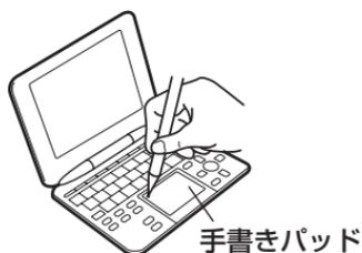
+マークは、タッチすると別の場所に表示されますので、順番にその交点にタッチしてください。+マークは4カ所に表示され、すべてタッチすると手書きパッドの表示濃度調整画面が表示されます。
