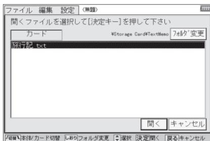
**参考** • カード内に複数のフォルダがある場合に、他のフォルダを選びたいときは **フォルダ変更** にタッチし、表示されるフォルダ名を選んで **OK** にタッチします。フォルダ名の前に田マークが表示されているときは、そのフォルダ内に別のフォルダがあることを示します。田にタッチすればそのフォルダ内のフォルダが表示されます。
