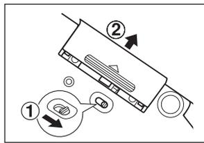
2 電池ぶたを矢印の方向に水平に引いて外します。
