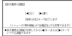
6 ◀(淡く)、▶(濃く)を押して、表示部の表示濃度を見やすい濃さに調整します。
