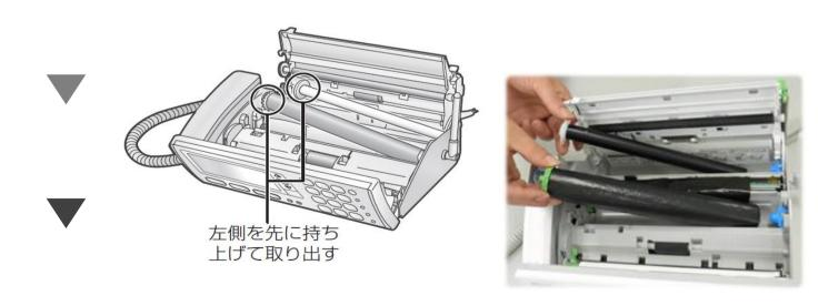
5. 新しいインクリボンを、向かって右側の青色の突起部分に 差し込み、取り付けます。
