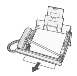
原稿送りローラーの右端を穴に差し込む
