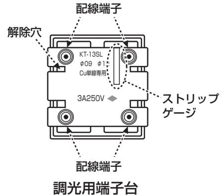
3 調光信号線をはさず場合は、電源を切り、解除穴をマイナスドライバーで直角に押しながら引き抜く。(ドライバーを傾けると調光端子台を破損するおそれがあります)
