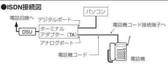
インターネットやパソコン通信にNTTのISDN回線(INSネット64)を利用する場合は、ISDNターミナルアダプター(TA)を用いて電話機とパソコンの両方を接続することができます。ISDN 回線を利用するには、NTTへの申し込みが必要です。
