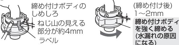
取り付け直すときは、締め付けボディをゆるめ、ねじ山が4mm程度見える状態でおこなってください。
