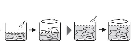
少ない水量の濃い洗剤液から洗い始め(高濃度洗浄)ガンコな汚れにしみ込ませて洗浄効果を高めます。
