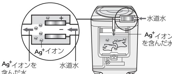
Ag<sup>+</sup>(銀)イオンは一部の防臭加工繊維製品をはじめ、多くの分野での利用が進められており、皮膚への安全性も確認されています。※2 この装置から最終すすぎ中にAg<sup>+</sup>イオンを含んだ水を給水し、衣類にAg<sup>+</sup>イオンを吸着させます。吸着したAg<sup>+</sup>イオンが衣類を細菌から守り(Ag<sup>+</sup>イオンコート)、室内干し時の気になるニオイや着用時の汗や皮脂によるニオイの発生を抑えるなど、衣類を清潔に保ちます。
