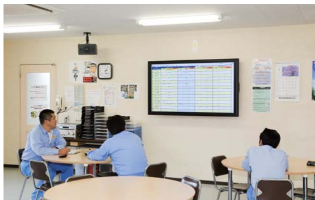
ドライバーの控え室に設置された配車指示表は15秒ごとに更新される。65インチ一画面に15車両の週間予定を表示可能。
