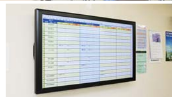
ドライバーの控え室に設置された配車指示表は15秒ごとに更新される。65インチ一画面に15車両の週間予定を表示可能。
