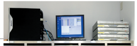
新本社ビルの警備室に設置された、『PN-455』の制御用PC。コンテンツの編集作業が行われている新聞製作センターのリモート用PCとは、社内LANで結ばれている。
